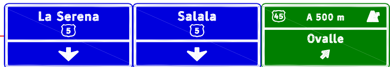
IP a 500 m de inicio pista salida
