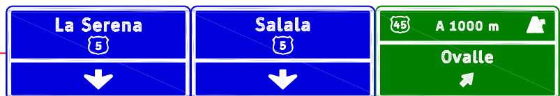
IP a 1000 m de inicio pista salida
